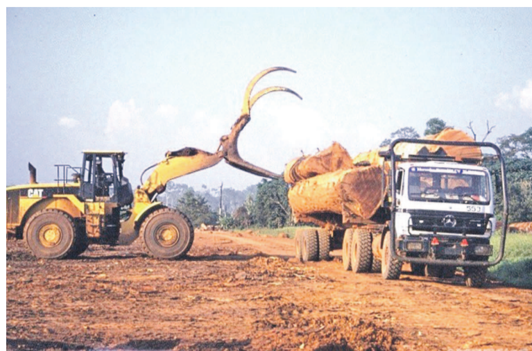
Chargement des grumes sur une remorque.
