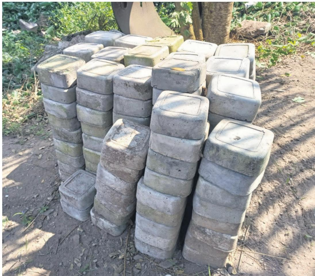
permettre de faire d'autres émules et grandir: Ces déchets, nous les broyons et les utilisons à la place du gravier; une fois en granulés, dans le ratio qui nous sert à produire les pa-
